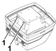
Регулярно очищайте датчик уровня воды (1) и проверяйте на наличие повреждений.
