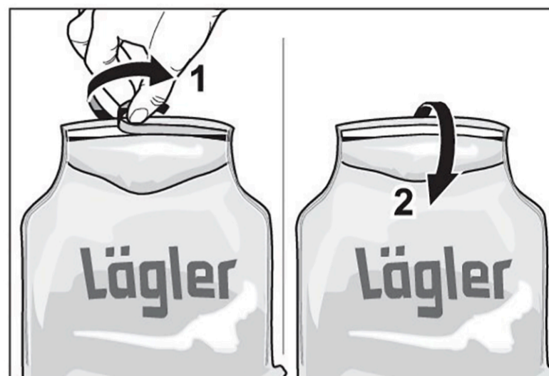
Изобр. 15 Удалите покрытие с липкой ленты и запечатайте мешок. Храните пылевой мешок на открытом воздухе!
