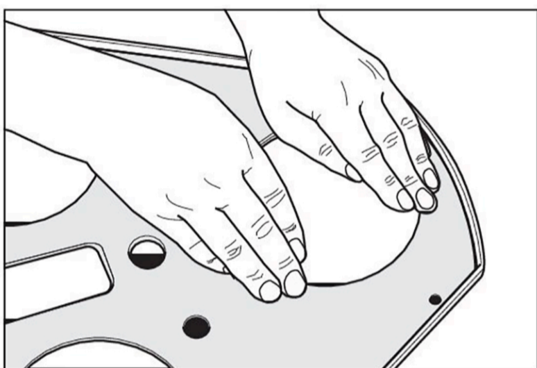
Изобр. 56 Прижмите уплотнительный войлок тщательно на всей площади, особенно по краям и вокруг выштамповок для оснастки шлифовального устройства.
