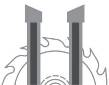
Пильный диск с разведенными зубьями (W/PW)
